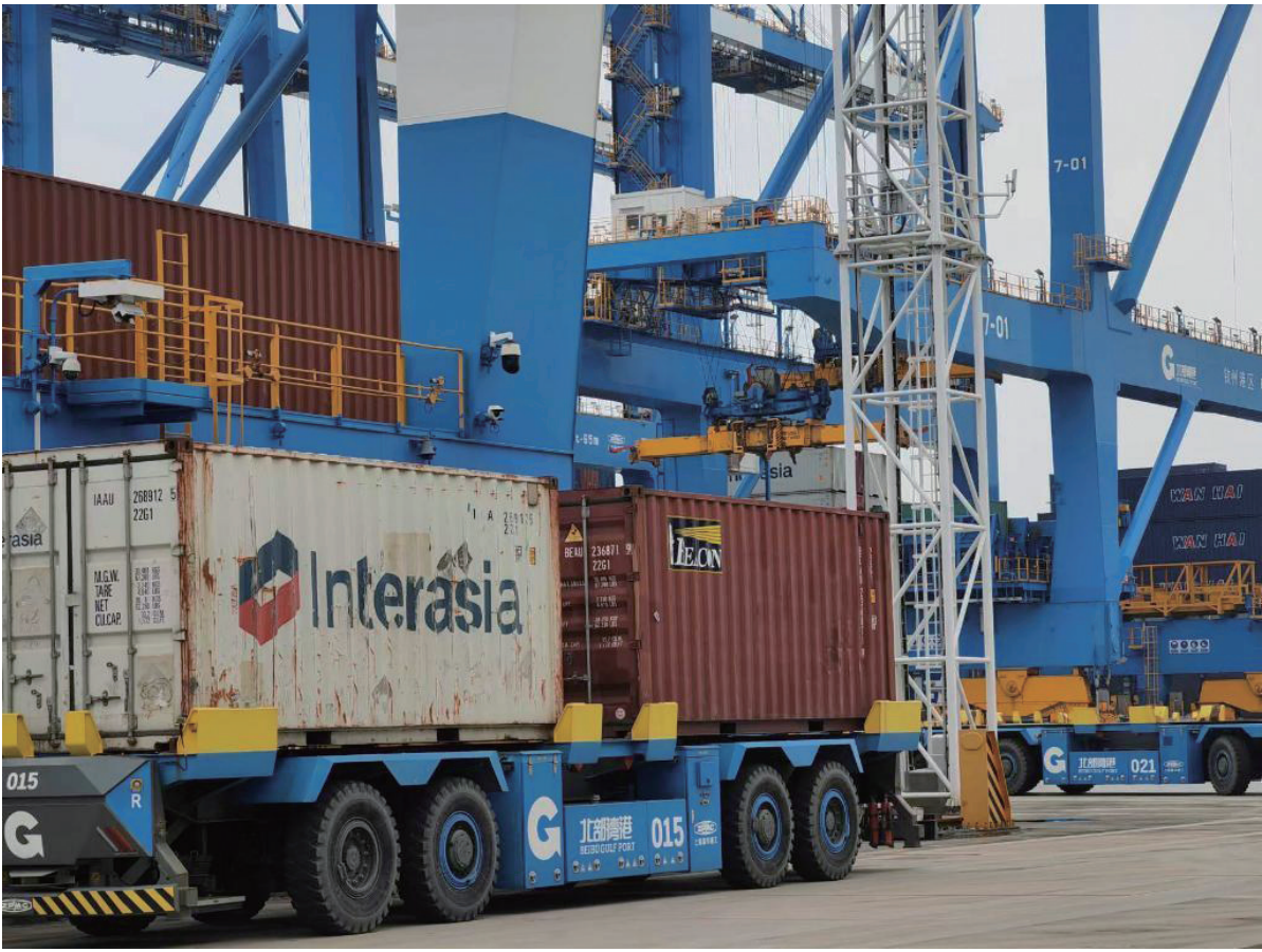
在钦州自动化集装箱码头,智能导引运输车在运送集装箱。新华社记者赵欢 摄
